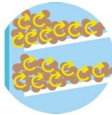
スクリーンが回転しながら上昇して行く際に、ろ過材にかかる遠心力により、渦流が形成されます。
