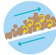
スクリーンにより運ばれる際に、ろ過材にかかる重力とスクリーンによる揚力により、渦流が形成されます。
